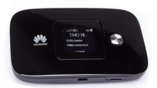
Attention: veuillez noter que, pour une mise à jour locale du firmware, le hotspot doit impérativement être connecté à l'ordinateur portable avec un câble USB!
